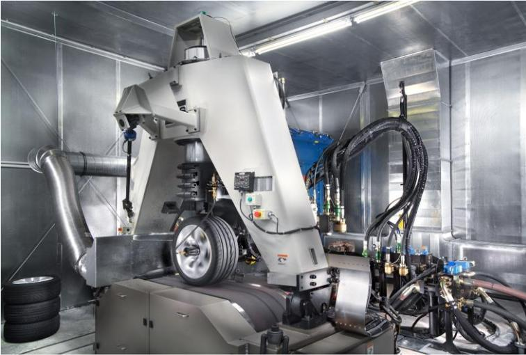
Abbildung 2.6: Flachbahnprüfstand der Firma IABG (Schmid & Förschl, 2009)
