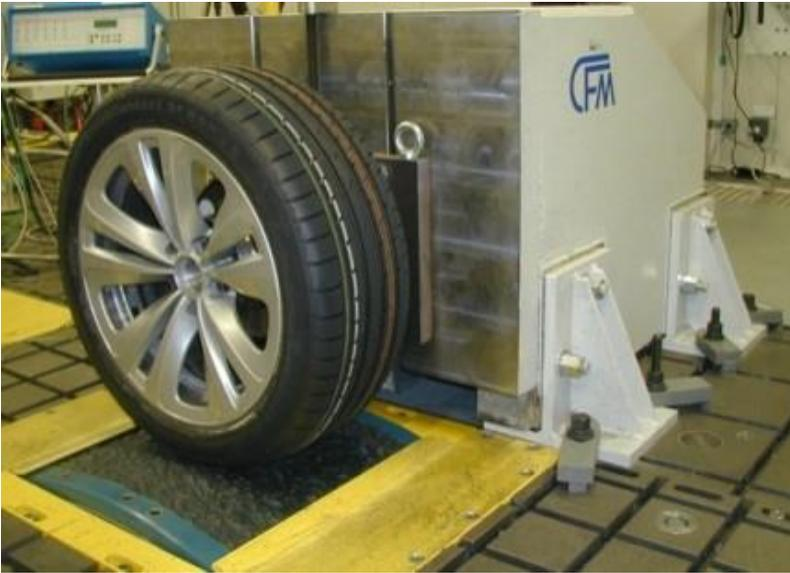
Abbildung 2.7: Außentrommelprüfstand zur Körperschallmessung
