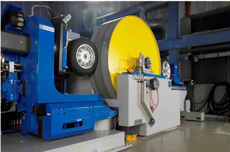
Abbildung 2.5: Außentrommelprüfstand zur Rollwiderstandsermittlung (Peckelsen, 2017)
