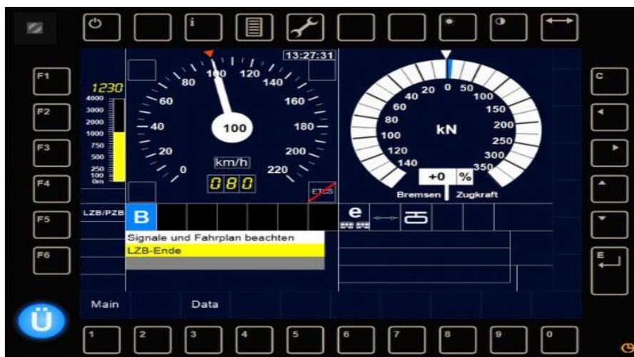
Abbildung 77: Multifunktionales Display für LZB-Führung [145]
