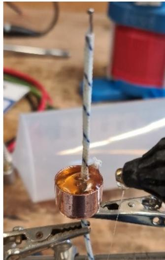
Abbildung 44: Abdichten der Thermoelement-Litze mit Heißkleber
