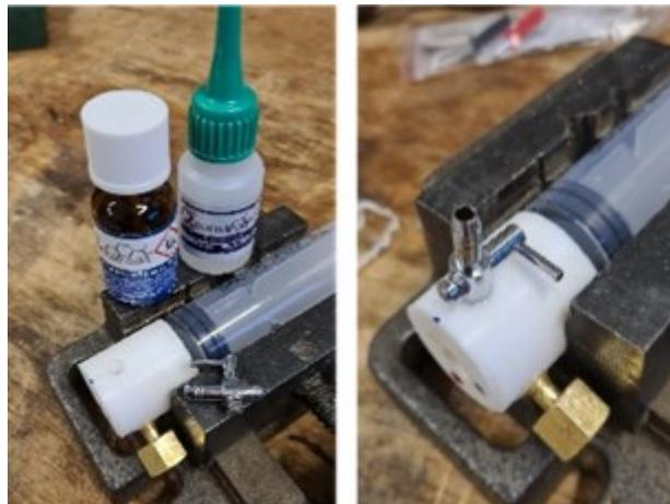
Abbildung 55: Vorbereiten der Kontaktflächen und Einkleben des Ventils
