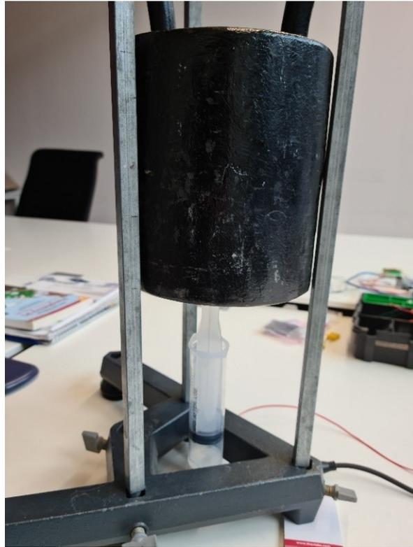
Abbildung 19: Versuchsaufbau für einen isobaren Prozess
