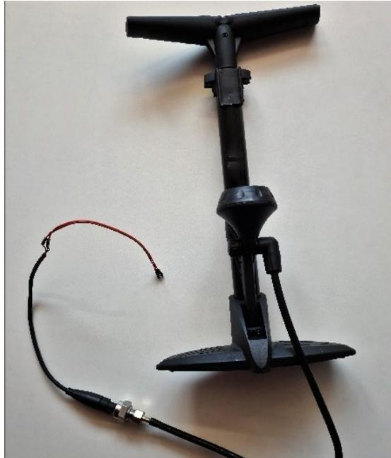
Abbildung 37: Fahrrad-Luftpumpe mit Manometer und Drucksensor
