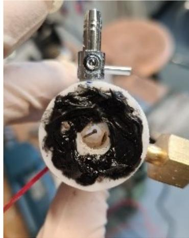
Abbildung 56: Ausrichten und Verkleben des Thermosensors und der Schlauchtülle
