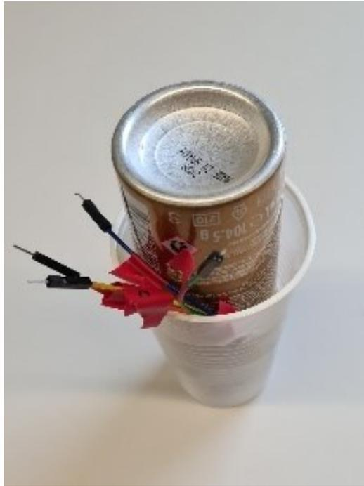
Abbildung 65: In Epoxidharz fixierter Spraydosenaufbau
