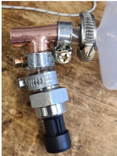
Abbildung 43: Anbindung des Drucksensors an Prototyp 1
