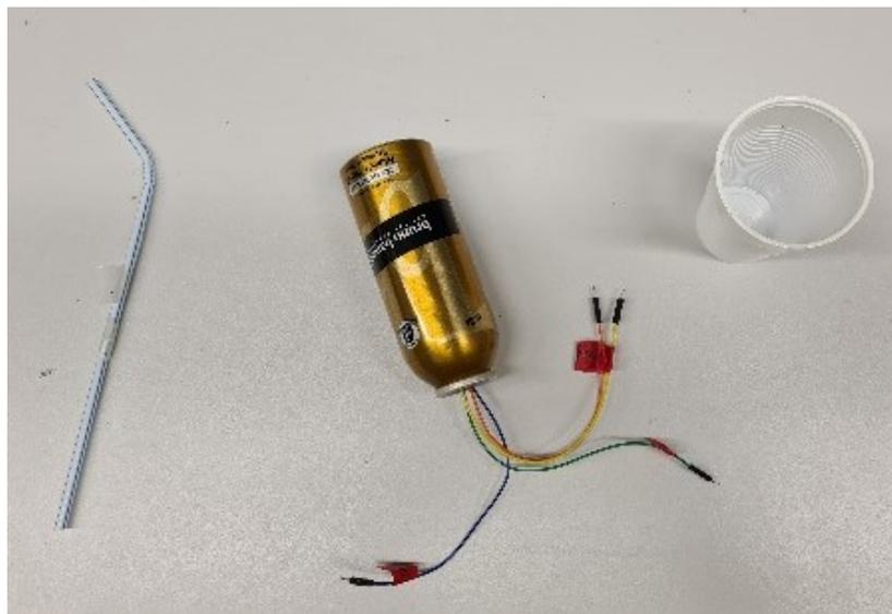
Abbildung 64: Vorpräparierte Spraydose mit Hilfsmitteln für den Umgang mit Epoxidharz
