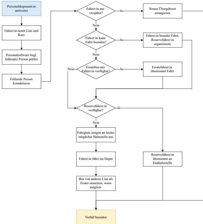
Abbildung 4.5: Ablauf des Anrufs bei fehlender Ablöse, nach [Briem u. a., 2022]
