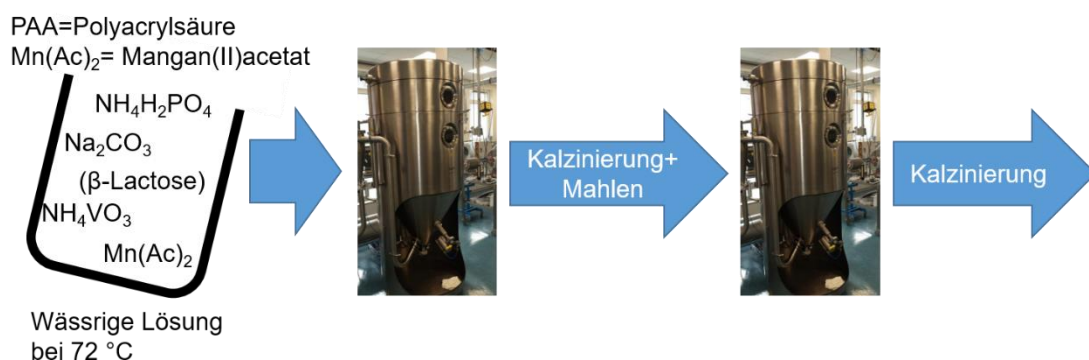
Abbildung 9: Schematische Darstellung der NMVP/C-Kompositsynthese analog der wässrigen NVP-Kompositsynthese bestehend aus Lösen der Edukte in H 2 O bei 72 °C, anschließender Sprühtrocknung, darauffolgender Kalzinierung inklusive Mahlvorgang, erneuter Sprühtrocknung und abschließender zweiter Kalzinierung.
