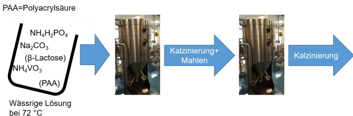
Abbildung 8: Schematischer Übersicht über die wässrige Synthese der NVP/C-Komposite bestehend aus Lösen der Edukte in \text{H}_2\text{O} bei 72 °C, anschließender Sprühtrocknung, darauffolgender Kalzinierung inklusive Mahlvorgang, erneuter Sprühtrocknung und abschließender zweiter Kalzinierung.
