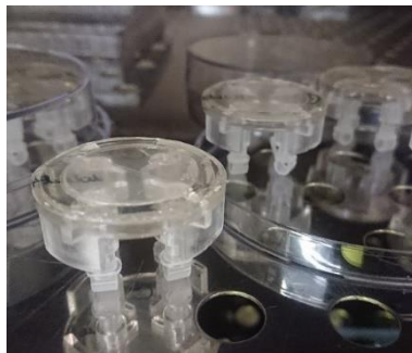
Abbildung 48: Besiedelungsmethode der Hepatozyten im umgebenden Kompartiment. Die Abbildung zeigt die um 180^\circ gedrehten vasQchips, wodurch eine gleichmäßige Verteilung der Hepatozyten an der Außenseite des Mikrokanals gewährleistet wird. Nach einer Inkubation über Nacht wurde für die anschließende Besiedelung der LSEC im Mikrokanal der vasQchip in seine ursprüngliche Position um 180^\circ gedreht.
