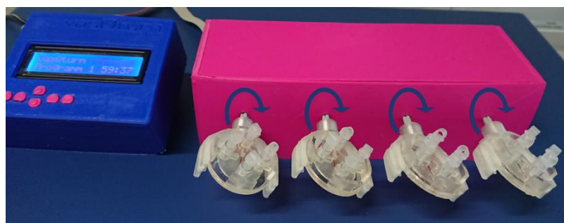
Abbildung 26: Darstellung des vasQturn zur Besiedelung des Mikrokanals des vasQchips mit Endothelzellen. Die mechanische Rotation entlang der Mikrokanalachse ermöglicht eine homogene Adhäsion der Zellen im halbzyklrischen Mikrokanal. Die Rotation wird mit 0,25 \text{ rpm} für 1 \text{ h} durchgeführt.
