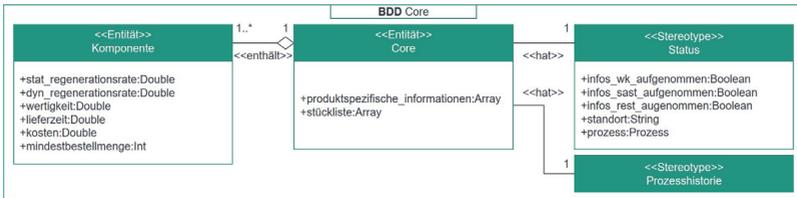
Abbildung 5.4: Blockdefinitionsdiagramm (BDD) der Entität Core (Goodall & Sharpe et al. 2019, A\_Eisen 2021).
