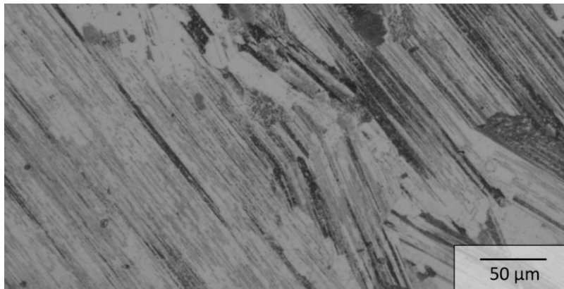
Abbildung 3.1: Ausgangsgefüge von Ti-48Al-2Nb-0,7Cr-0,3Si. Aufnahme am Lichtmikroskop im Hellfeld Modus.
