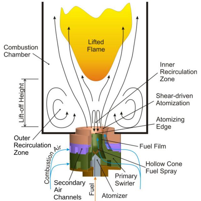
**FIGURE 2.** SCHEMATIC OF THE LIFTED FLAME BURNER ADAPTED FROM [23].
