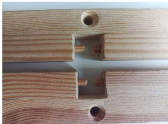
Abbildung 4.14.: Geöffnetes Zauberkreuz. Die horizontal beweglichen Stifte in den Innenseiten können mit den Löchern des Gegenstücks einen Formschluss bilden.
