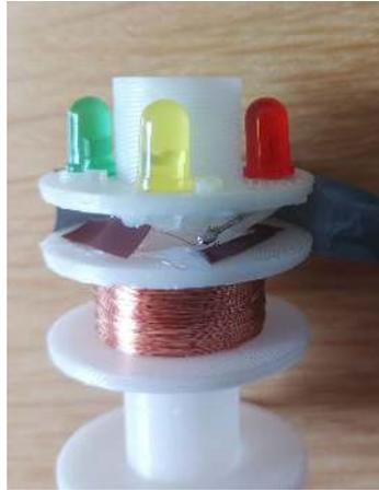
Abbildung A.4.: Lötstelle des Kupferlackdrahtes an der low-current LED, integriert in dem 3D gedruckten Induktionsspulen-Konstrukt.
