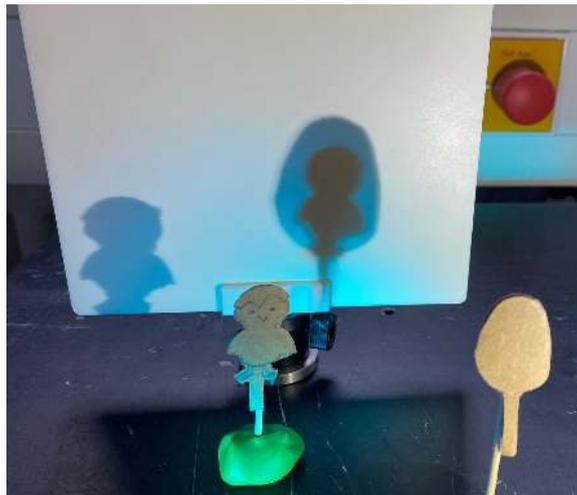
Abbildung A.13.: Erste Version des Rätsels **Schattenphänomene**. Mithilfe der Pappe Figuren und zwei Lichtquellen wird der Kernschatten und der blaue Halbschatten erzeugt.
