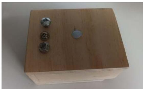
Abbildung 4.7.: Farbmischer für das optische Rätsel **Farbaddition**. Die Schrauben kleben auf darunter liegenden Tastern.
