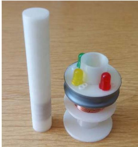
Abbildung 4.12.: Induktionsspule (rechts) mit passendem Magnetstab (links), welcher bei schnellem Hin- und Herbewegen in der Spule einen Induktionsstrom erzeugt. Daraufhin leuchtet die rote LED, neben welcher die Lösungszahl 3 steht. Die grüne und gelbe LED sind nicht angeschlossen. Hinter dem grauen Klebeband befinden sich die Lötstellen.
