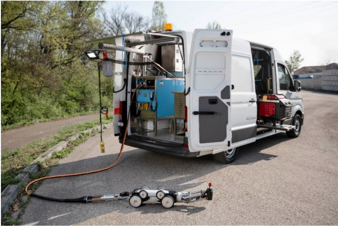
Abb. 4.10 Einsatzwagen und Ausstattung für Robotereinsatz im Kanalnetz
