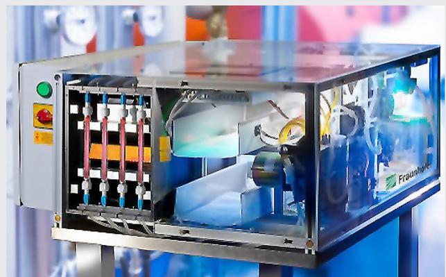
Im biologischen Breitbandsensor »AquaBioTox« werden Mikroorganismen kontinuierlich mit Trinkwasser umspült. Eine Kamera mit automatischer Bildauswertung detektiert Veränderungen, bei denen ein Alarmsignal ausgelöst wird.
