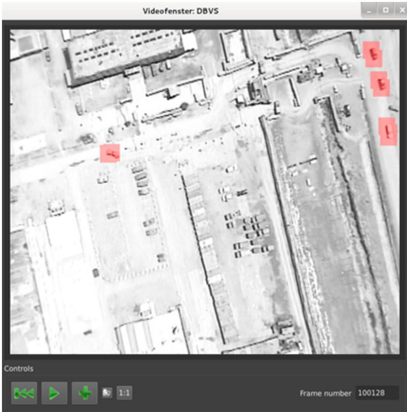
**Abbildung 6.7:** Szene mit IMD-Verfahrensergebnissen als rote Hervorhebungen durch das Versuchssystem.
