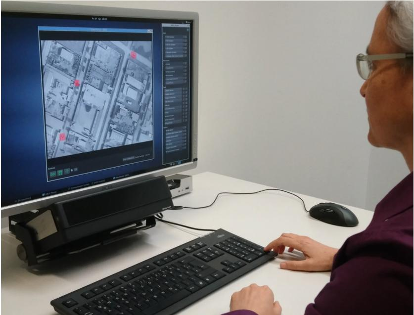
**Abbildung 2.3:** Remote-Eyetracker Tobii X60, platziert unterhalb des Bildschirms.
