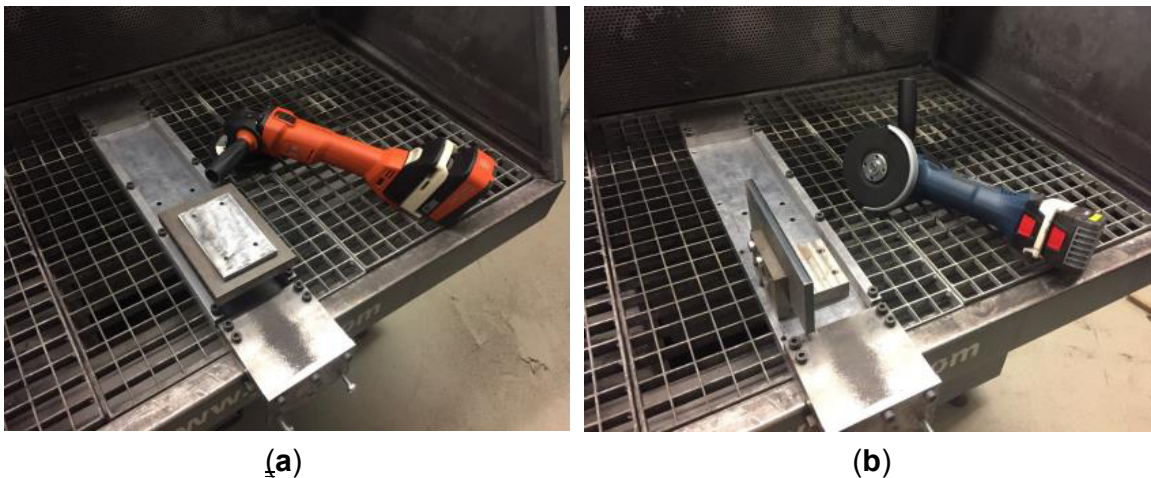
Abbildung 5.2: CCG18 mit Sensormodul und Versuchsaufbau T2 mit dem Werkstück zur Tätigkeit Schleifen mit einer Fächerschleifscheibe (a) und GWS18 mit Sensormodul und Versuchsaufbau T2 mit dem Werkstück zur Tätigkeit Schruppen mit einer Schrappscheibe (b). (Dörr, Spoden et al., 2022, S. 3)
