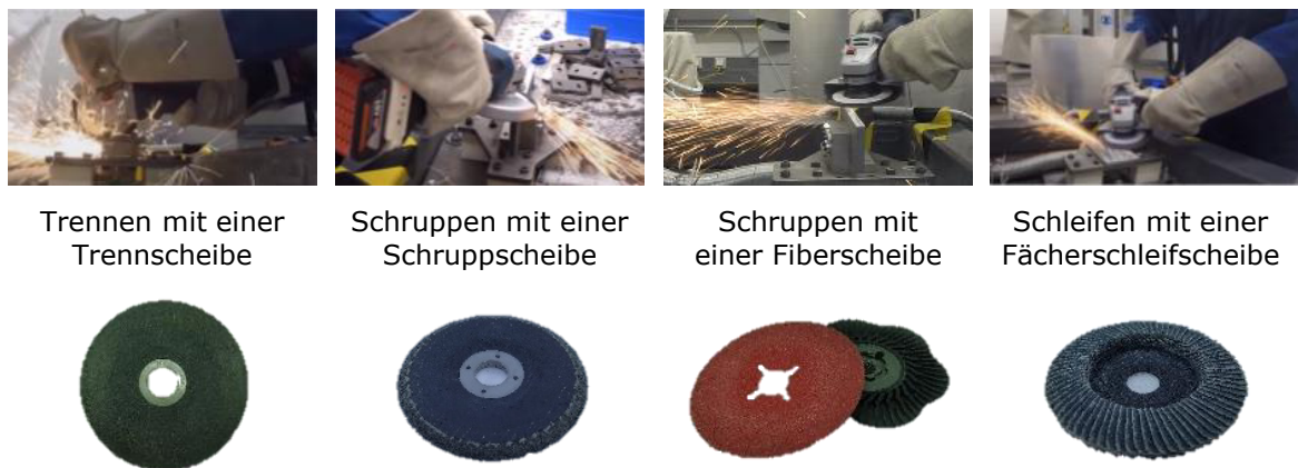
Abbildung 5.1: In der Studie wurden vier Tätigkeiten mit unterschiedlichen Werkzeugen durchgeführt. In Anlehnung an Dörr, Ott et al. (2021, S. 4)
