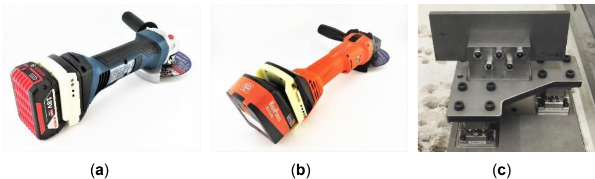
Abbildung 6.1: Verwendete Winkelschleifer mit passendem Sensormodul und Versuchsaufbau zur Messung der Kräfte im Werkzeugkontakt: Winkelschleifer GWS18 (a), Winkelschleifer CCG18 (b) und Versuchsaufbau T1 mit der Stahlprobe für die Tätigkeiten Schruppen mit einer Schrappscheibe und Schruppen mit einer Fiberscheibe (c). (Dörr, Ott et al., 2021, S. 4)
