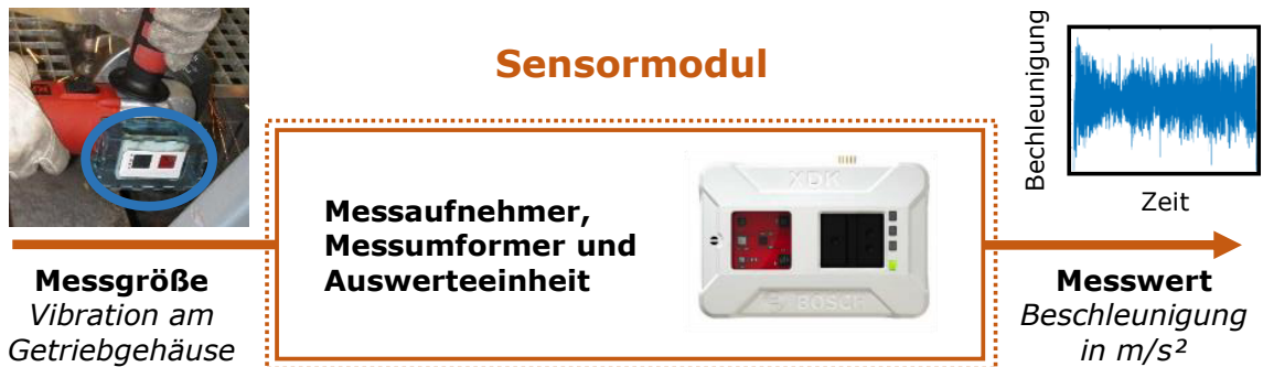
Abbildung 2.12: Anwendung des Sensormoduls Cross-Domain Development Kit XDK 110 (Robert Bosch GmbH, Gerlingen-Schillerhöhe, Deutschland) am Beispiel der Vibrationsmessung am Getriebegehäuse eines Winkelschleifers.
