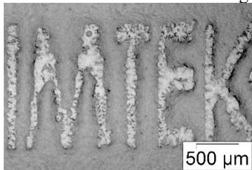
**Bild 6:** Gedrucktes IMTEK Emblem mit der Tinte DVB45, einfache Schicht, 450x450 dpi.
