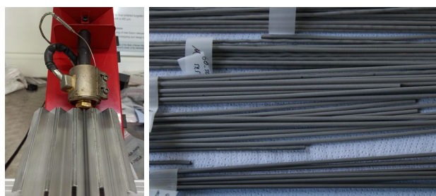
Bild 4 Filamente mit 60 Vol% Ti6Al4V. Links: Filamentextrusion; rechts: Filamente unterschiedlicher Binderszusammensetzung.
