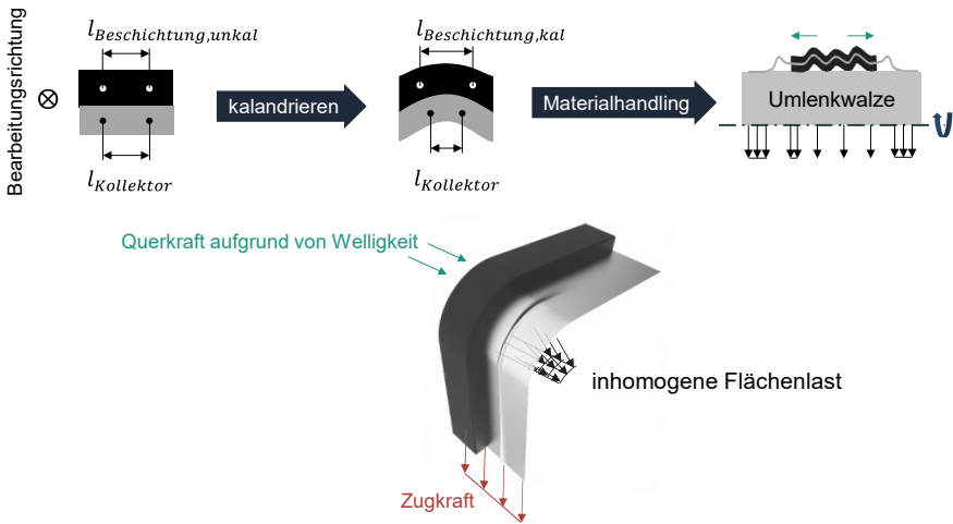
Abbildung 3-9: Faltenbildung an einer Umlenkwalze
