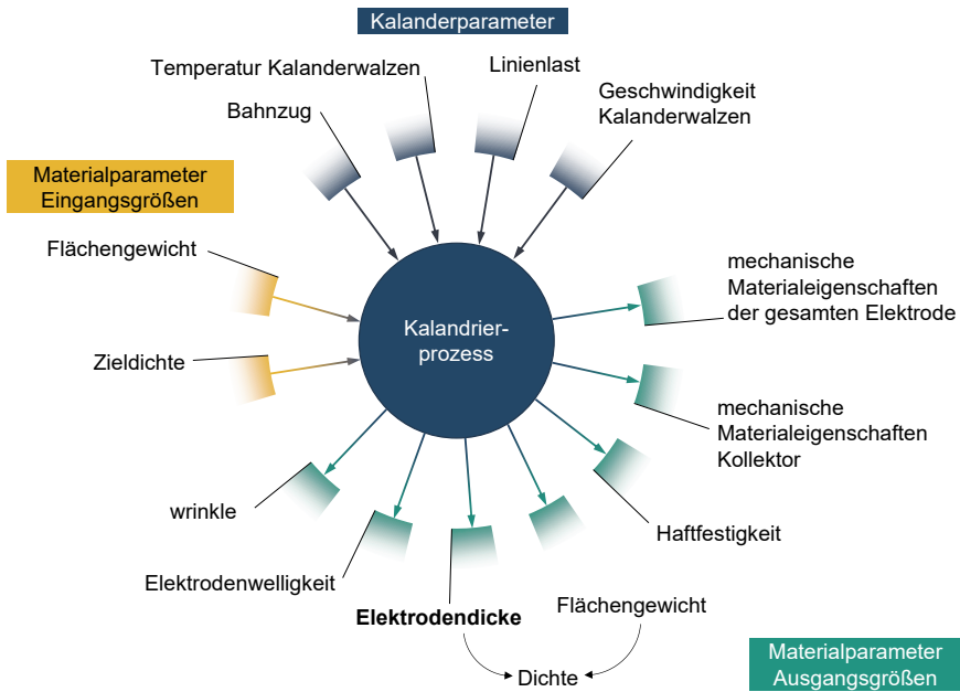
Abbildung 2-12: Prozess- und Materialgrößen für das Kalandrieren im Überblick
