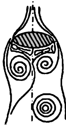
Abbildung 3-9: Erläuterung zum taumelnden Aufstiegsverhalten von Einzelblasen, bearbeitet nach Lindt 1971 [60].
