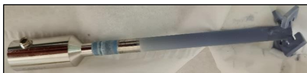
Abbildung 48: Fotografie des Rührers nach 44 h im Versuch mit 300 mg \text{Co}_2(\text{CO})_8 .
