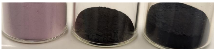
Abbildung 80: Fotografie des Co/Al 2 O 3 Katalysators. Von Links: Nach Imprägnierung, Nach Kalzinierung, Nach Reduktion.
