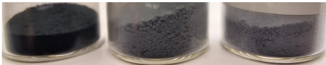
Abbildung 73: Fotografie der Ru-HBEA Katalysatoren nach der Kalzinierung. Von links: Ru-HBEA25, Ru-HBEA38, Ru-HBEA308.
