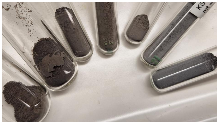
Abbildung 77: Fotografie der Ruthenium auf Zeolith Katalysatoren im reduzierten Zustand. Ru-Y, Ru-B, Ru-F, Ru-M, Ru-Z-30, Ru-Z-80, Ru-Z-280.
