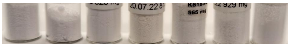
Abbildung 75: Fotografie der Zeolith Trägermaterialien. Der BEA Zeolith musste, da er in der Ammonium Form gekauft wurde vorher kalzinieren werden. Von links: H-Y-30, H-BEA-25, H-FER-20, H-MOR-20, H-ZSM-5-30, H-ZSM-5-80, H-ZSM-5-280
