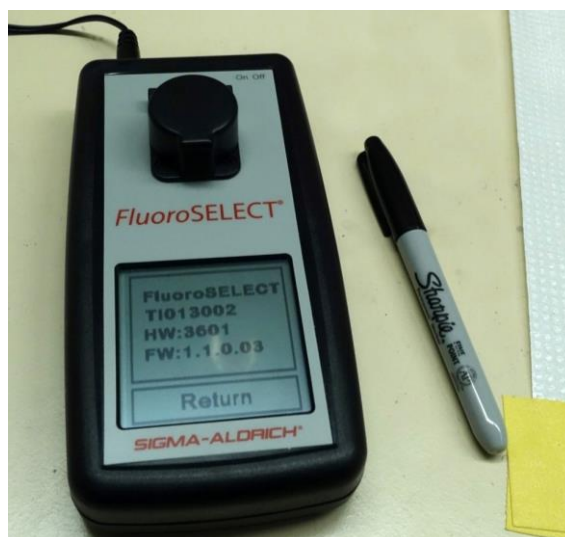
Abbildung 16: FluoroSELECT Fluorometer der Fa. Sigma Aldrich zur Analyse von Fluoreszenzfarbstoffen mit einem Absorptionsmaximum von 300-400 nm und Emissionsmaximum von 400-500 nm.
