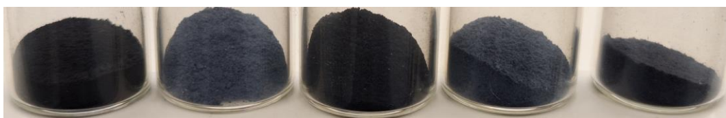
Abbildung 83: Fotografie der X/Co/Al 2 O 3 Katalysatoren im reduzierten Zustand. Von links: Ohne Promotor, Ru, Pd, Pt, Au.
