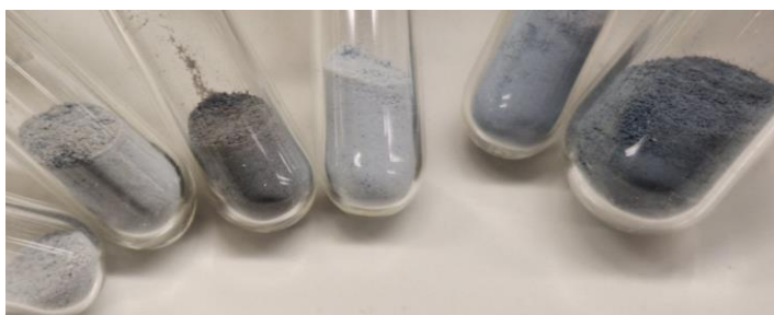
Abbildung 69: Fotografie der Ruthenium Katalysatoren im reduzierten Zustand. Von links: Ru-NO-1, Ru-NO-3, Ru-NO-5, Ru-Cl-1, Ru-Cl-3 und Ru-Cl-5.
