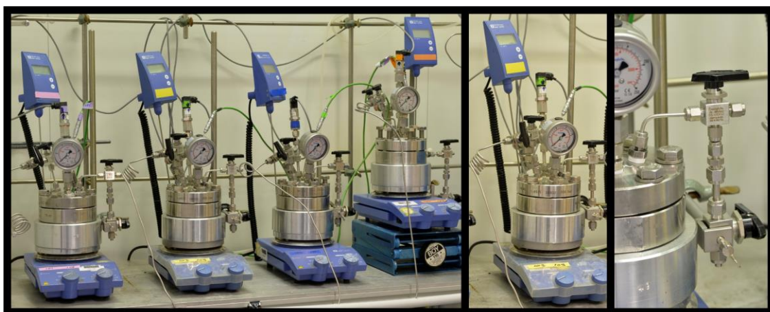
Abbildung 13: Links: Ansicht der vier Autoklaven, Rechts: Probenschleife zur Entnahme einer flüssigen Probe während des Versuchs. Die Reaktoren sind bis max. 250 °C, max. 200 bar und 75 ml ausgelegt.
