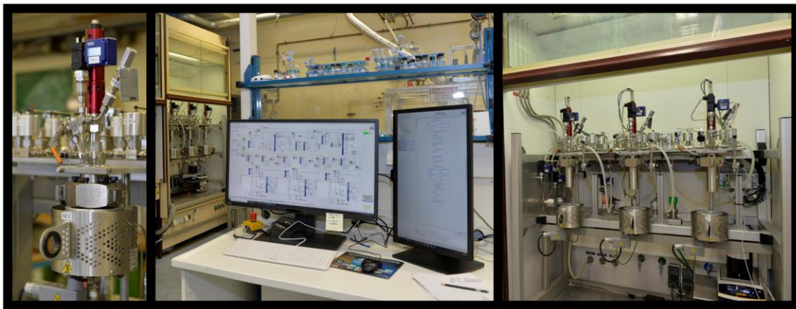
Abbildung 14: Links: Nahansicht des Reaktors 2, Mitte: Steuerungssoftware für die PASCAR, Rechts: Anlage mit heruntergefahrenen Heizmänteln. Druck max. 175 bar, CO:H 2 große Bandbreite, Temperatur max. 200 °C, Volumen: ca. 100 ml, max. 1300 RPM Rührung.
