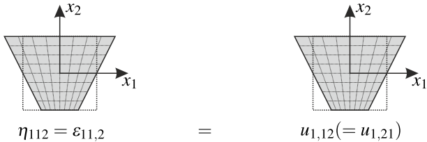
Abbildung 2.3: Verschiebungsfeld eines homogenen Verzerrungsgradientenzustandes mit einzig von Null verschiedener Komponente \eta_{112} , wobei u_1(x_1, x_2) = u_{1,12}x_1x_2 ( u_{1,12} = \text{const.} ).
