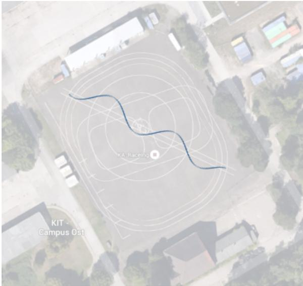
Abbildung 4.16: Automatisierte Slalomfahrt mit Lenkwinkel und Geschwindigkeitsvorgabe auf dem Versuchsgelände am KIT Campus Ost
