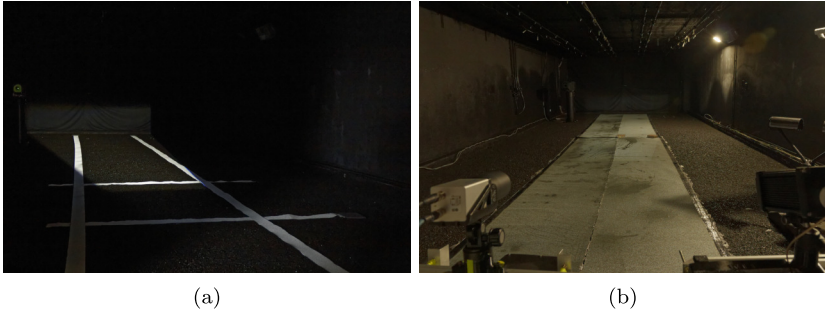
Abbildung 6.8: Fotos von den (a) Fahrbahnmarkierungen und den (b) hellgrauen Teermatten in der Nebelkammer.
