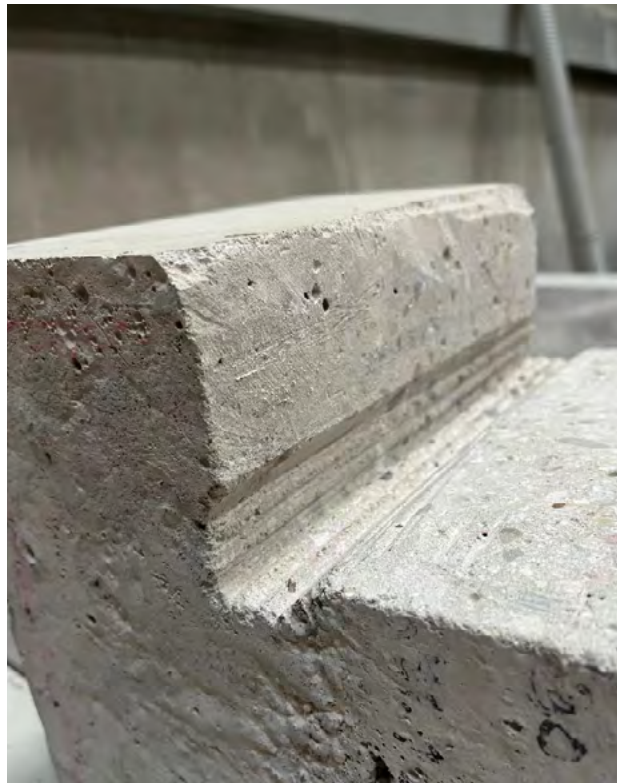
Abb. 5 Innenkante nach der Bearbeitung mit dem EKONT-Werkzeug.
