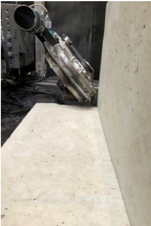
Abb. 4 Innenkante aus Betonkörpern vor der Bearbeitung. Fotos: KIT TMB
