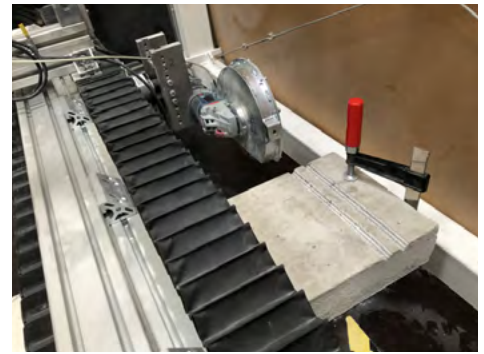
Abb. 7 Bearbeitungstest in der horizontalen Ebene bei der Betonfestigkeit C25/30.
