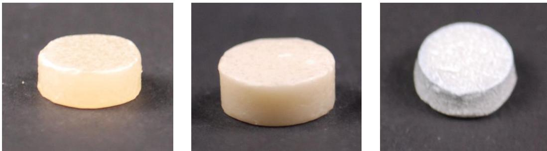
Abbildung 66: Beispielbilder von in Sauerstoff (links), Luft (mitte) und Stickstoff (rechts) gesinterten BT-BNT Proben.
