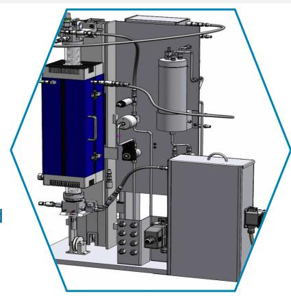
**New LOCA apparatus**. Figure source: Studsvik
