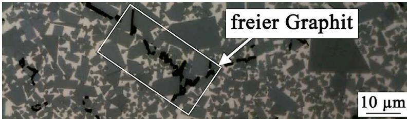
Abbildung 6: Bildung von freiem Graphit bei C-Überschuss, dargestellt an einer WC-10Co-(Gew.-%)-Mikrostruktur; zugeschnittene Darstellung von [42]; Markierung des freien Graphits ergänzt.
