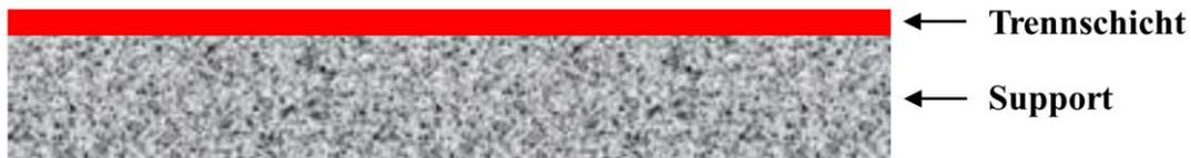
**Abbildung 28:** Aufbau einer asymmetrischen hydrophoben Polymermembran für die gas/flüssig-Phasentrennung in einem Mikrokontaktor.
