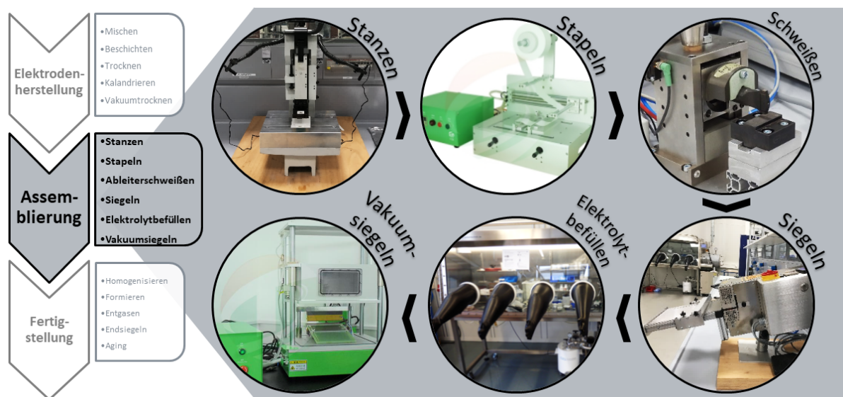
Abbildung 3.2: Schematische Darstellung der Prozessschritte zur Herstellung der verwendeten Pouchzellen.
