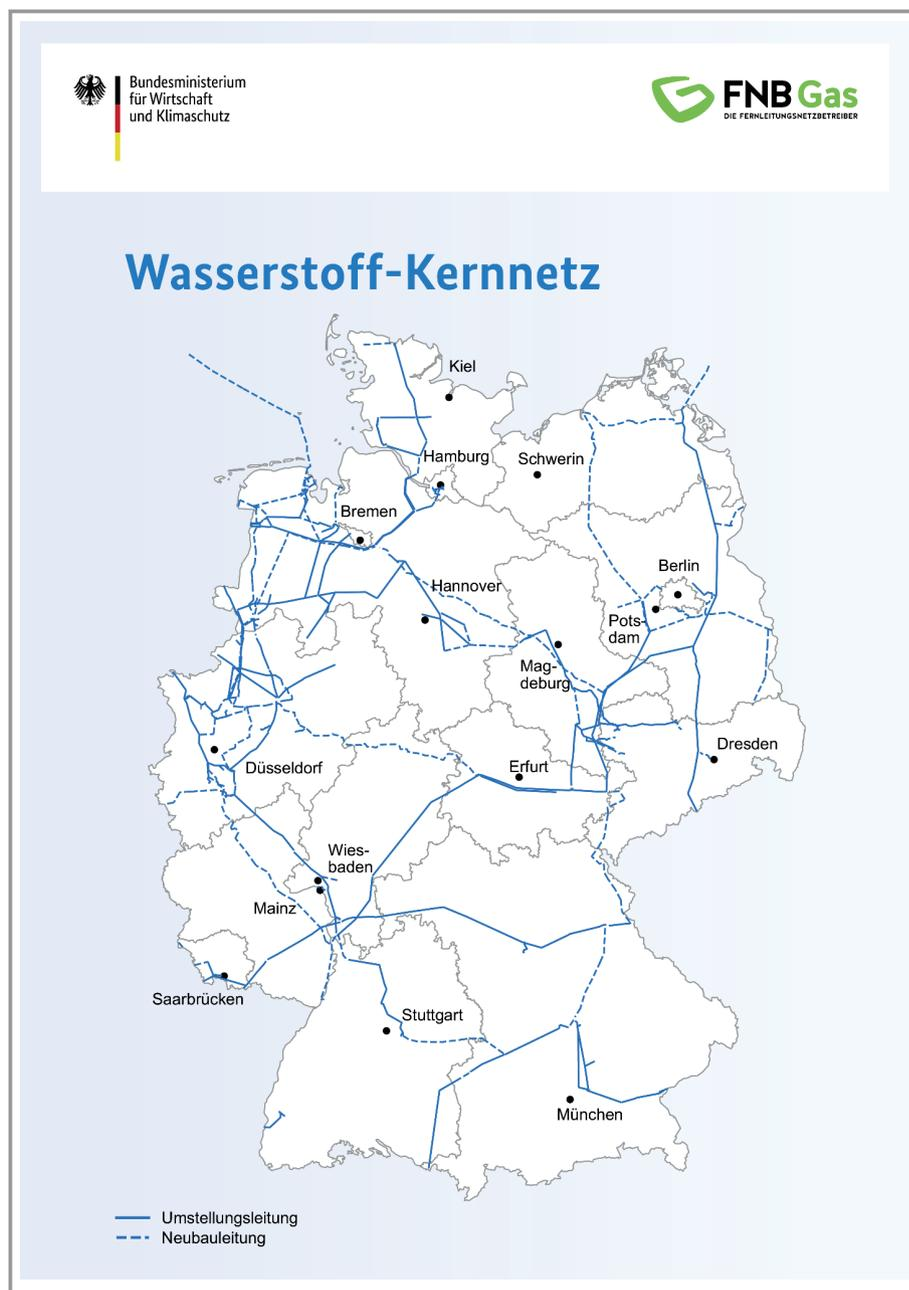
Abbildung 4. Geplantes Wasserstoff-Kernnetz Deutschland 2032, Quelle FNB Gas [47].
