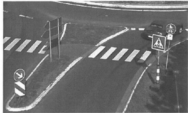
Fahrbahnteiler mit dem Fahrverlauf angepassten Rändern (M KV, 2006)
