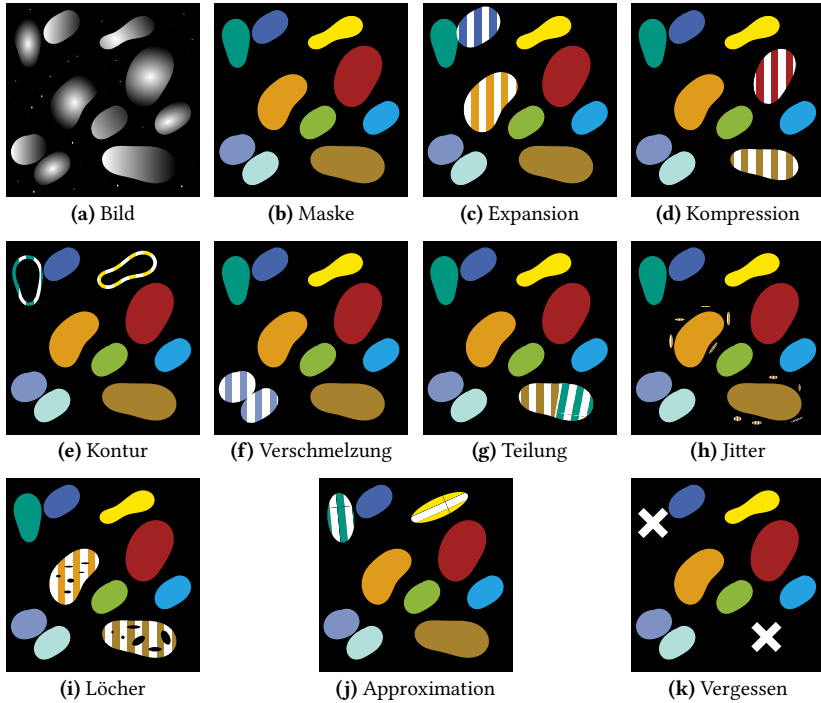
Abbildung 3.7: Synthetischer Datensatz der Instanzsegmentierung inklusive Verunreinigungen. Ein exemplarisches Bild (a) mit der korrespondierenden fehlerfreien Instanzmaske (b) wird verschiedenen Verunreinigungen (c)-(k) gegenübergestellt, wobei betroffene Instanzen mit weißen Linienmustern/Kreuzen gekennzeichnet sind. In diesem Beispiel beträgt der Parameter \beta = 0.2 (siehe Details in Abschnitt 3.4.2), da zwei von zehn Instanzen verändert worden sind [Sch22b, Sch23c].
