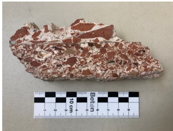
Abb. 1: Stück eines römischen Opus Caementitium. Es sind zwei Schichten mit unterschiedlich großen Ziegelbruchstücken zu erkennen. Bild: IZB, D. Bosold
