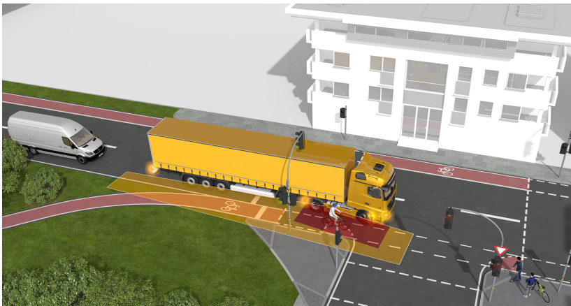
Abbildung 2.7: Beispielszenario für den Eingriff eines Abbiegeassistenten, Daimler Truck AG
