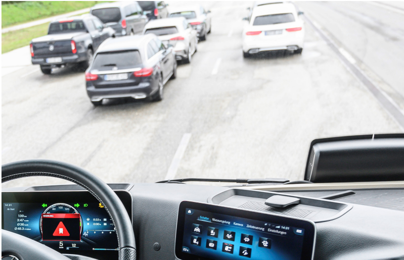
Abbildung 2.6: Beispielszenario für den Eingriff eines Notbremsassistenten, Daimler Truck AG
