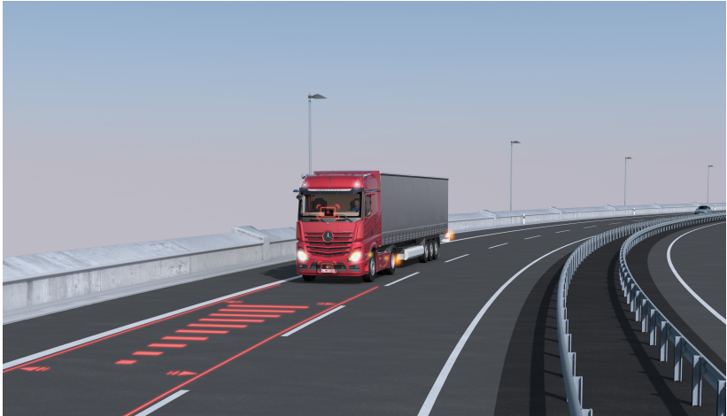
Abbildung 2.5: Illustration von Spurhalteassistent und ACC in Kombination, Daimler Truck AG
