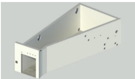
Abbildung 5 : BIM-Modell mit Störobjekten für die Wände sowie die Decke des Raumes
