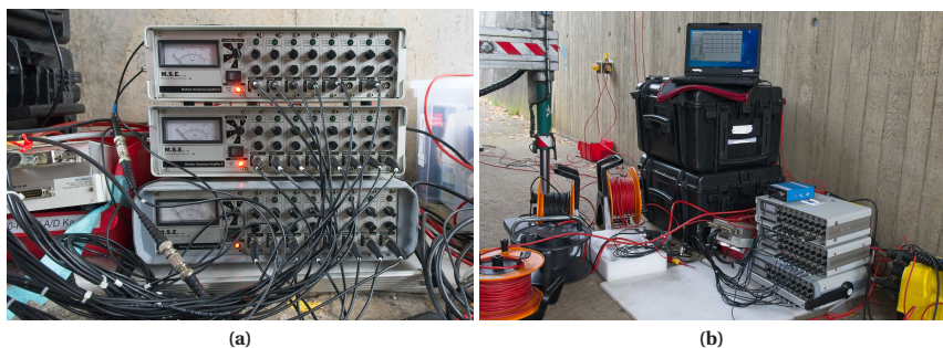
Abbildung 6.6: Beispielhafte Darstellung der Signaldigitalisierung vom Verstärker bis zur Software: a) AD-Wandler und Verstärker im Detail, b) Übersicht
