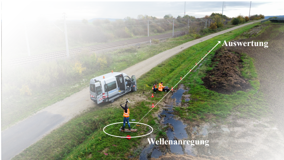
Abbildung 2.15: Messung dynamischer Bodenparameter mittels MASW-Methode
