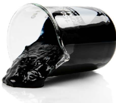
Abbildung 4.1.: Drucktinte mit PEDOT Nanowires. Bildquelle: Entnommen aus Aslan Ref. [34], veröffentlicht unter CC BY 4.0-Lizenz ( open access , https://creativecommons.org/licenses/by/4.0/ ).
