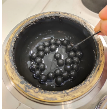
Abbildung 4.3.: Drucktinte mit Silberselenid im Mahlbecher mit Mahlkugeln. Bildquelle: © 2022 Leonard Franke, reproduziert mit Erlaubnis.
