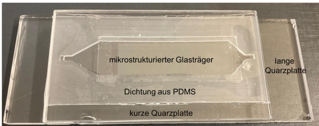
Abbildung 9: Der Glasträger wird mit Hilfe einer Kunststoffdichtung passend zwischen zwei großen Quarzglasplatten gepresst und über Öffnungen in der Dichtung mit dem Fluidiksystem verbunden. Zwischen dem Träger und der langen Glasplatte entsteht ein Fluidikkanal, in welchem nach der Befüllung eine Kontaktfläche zwischen Mikrostrukturen und Bakteriensuspension entsteht. Das Bild wurde mit der Erlaubnis des Autors, Zekun Zhou, verändert und übernommen [44].
