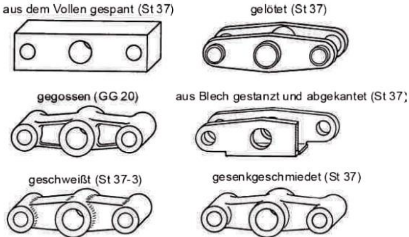
Abbildung 2.1: Änderung der Gestalt bei Variation des Fertigungsverfahrens aus Ehrlenspiel und Meerkamm (2017, S. 574)
