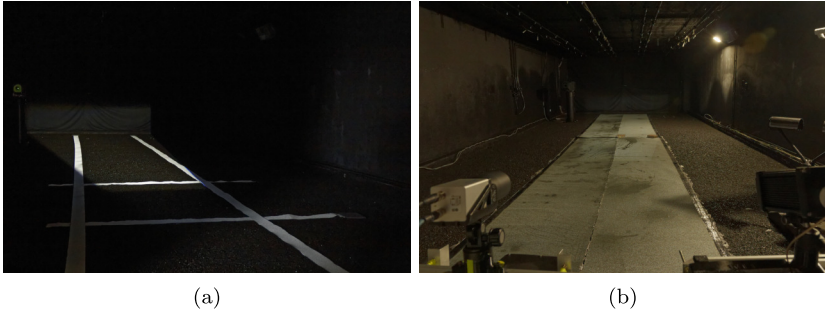
Abbildung 6.8: Fotos von den (a) Fahrbahnmarkierungen und den (b) hellgrauen Teermatten in der Nebelkammer.
