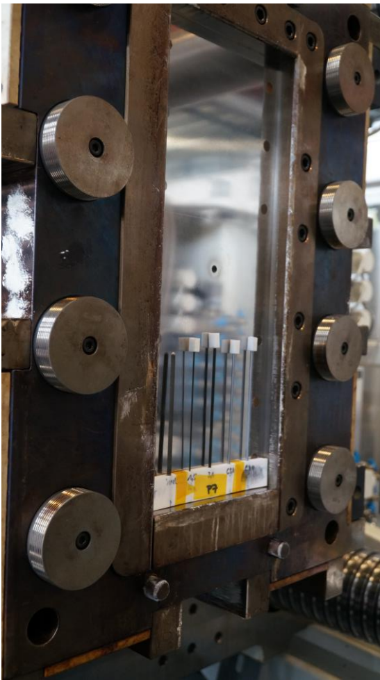
Abbildung 4-12: Fünf Probekörper aufrechtstehend im Umspritzwerkzeug
