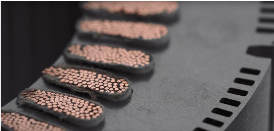
Abbildung 2-25: Aufgeschnittener Stator des Tesla Model 3 [54]
