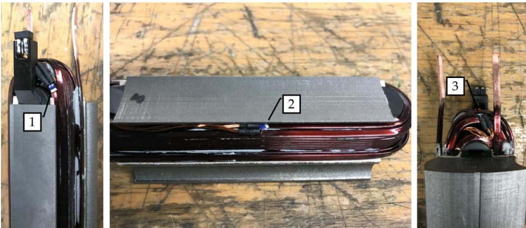
Abbildung 6-17: Position der Temperatursensoren innerhalb des Motors
