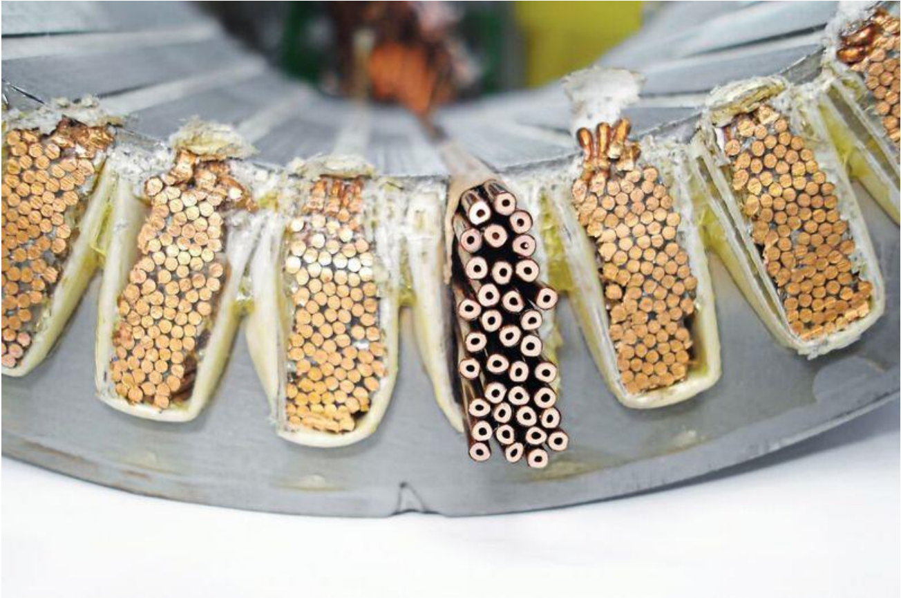
Abbildung 2-22: Fluiddurchströmte Hohlleiter, exemplarisch in einer Nut [48]
