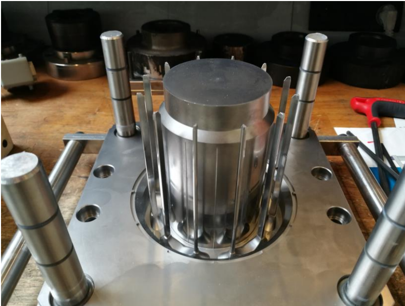
Abbildung 5-4: Unterteil des Werkzeugs zur Statorumspritzung
