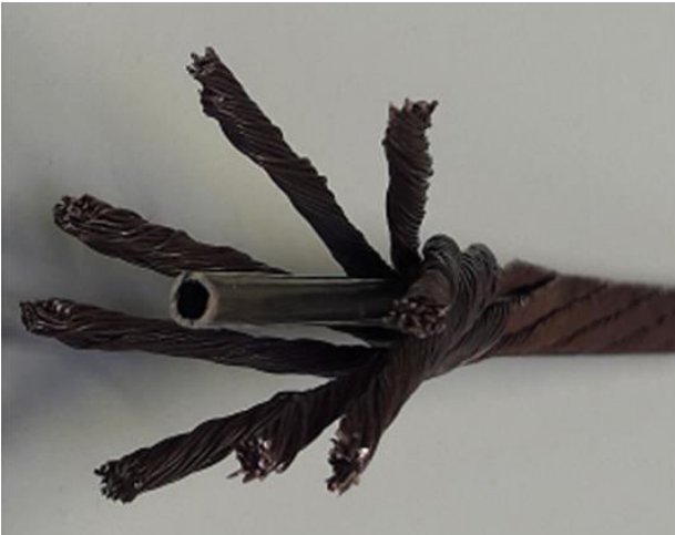
Abbildung 2-23: Aufgetrennte Wickellitze mit mittiger Edelstahlleitung [49]
