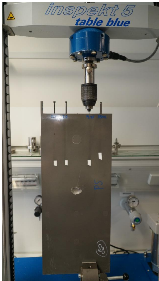
Abbildung 4-13: Ausziehversuch der Werkzeugkerne
