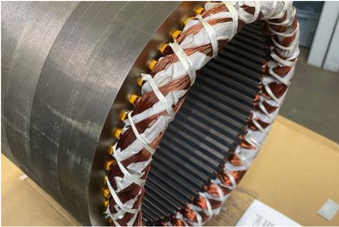
Abbildung 2-9: Bandagierter Wickelkopf mit Phasentrennern [24]
