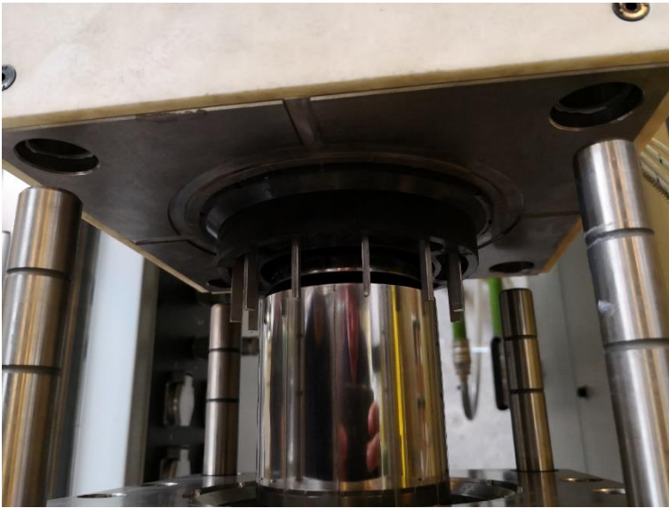
Abbildung 5-7: Abgerissene Kerne und feststeckender Stator im Werkzeug
