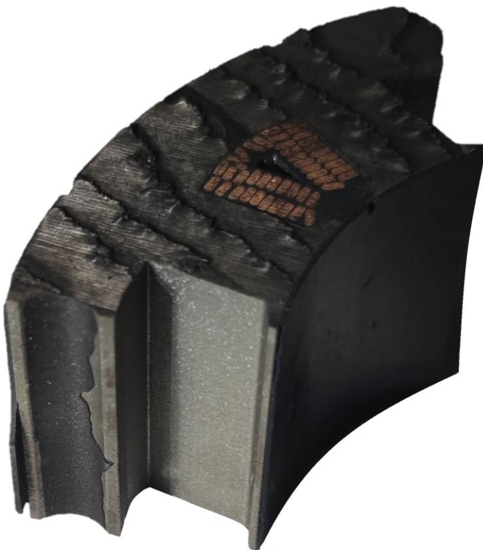
Abbildung 6-2: Zahnsegment mit Kunststoff zwischen den Einzelzähnen
