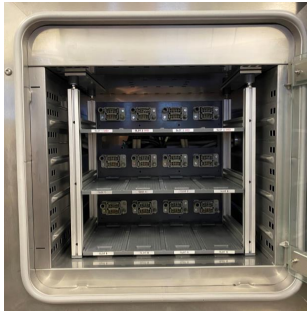
Abbildung A.1: a) Einschubsystem des Friocell Klimaschranks (vgl. Tabelle A.4) mit 12 Einschüben, b) Steckerbelegung des Pouchzellschlittens, c) Steckerbelegung des PAT-Cell Zellschlittens.
