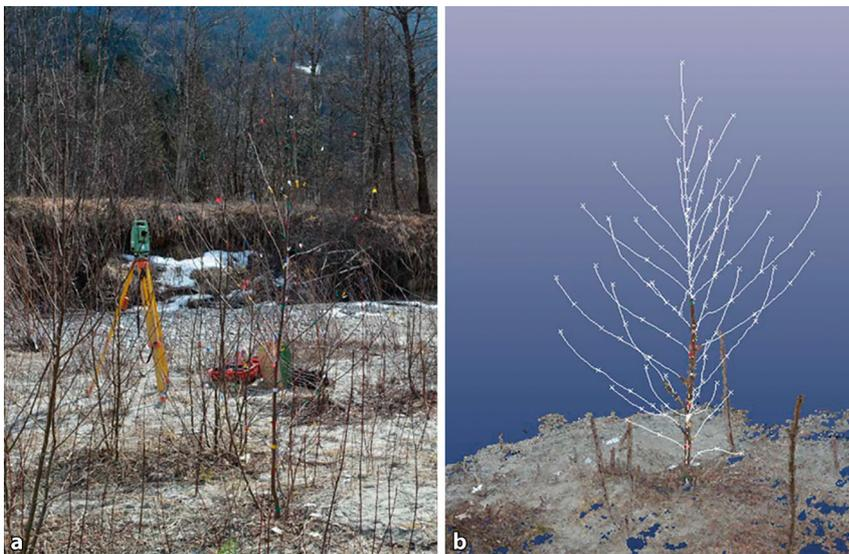
**Abb. 1** **a** Farbige Markierung der Äste einer Grau-Erle (*Alnus incana*) zur erleichterten Identifizierung der Äste in der fotogrammetrischen Auswertung sowie Vermessung von Targets zur Orientierung im übergeordneten Koordinatensystem und für ein korrektes Größenverhältnis, **b** anhand der Software Photomodeler erhaltene, dreidimensionale Pflanzenstruktur und Geländeoberfläche
