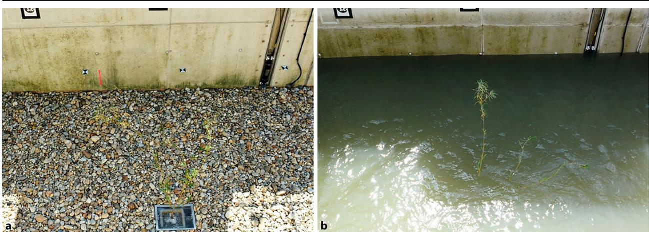
**Abb. 4** a In die Kraftaufnehmerbox eingebaute Korbweide (*Salix viminalis*), b Messung der Strömungskraft bei Anströmung
