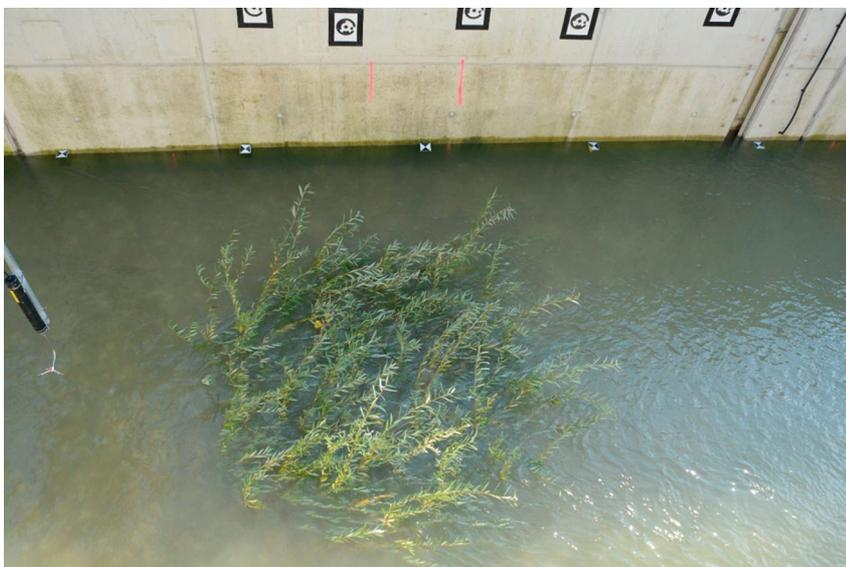
**Abb. 5** Kreisförmig angeordneter Verband mit Silberweiden (*Salix alba*) im Forschungsgerinne des BOKU-Wasserbaulabors
