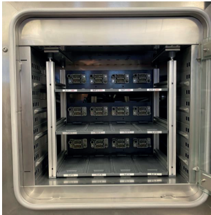
Abbildung A.1: a) Einschubsystem des Friocell Klimaschranks (vgl. Tabelle A.4) mit 12 Einschüben, b) Steckerbelegung des Pouchzellenschlittens, c) Steckerbelegung des PAT-Cell Zellschlittens.
