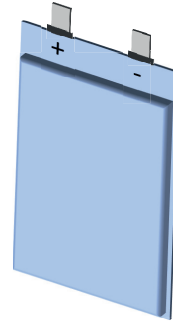
Abbildung 2.4: Schematische Darstellung der gängigsten Zellformate für Lithium-Ionen-Batterien: a) Zylindrische Zelle, b) Prismatische Zelle und c) Pouchzelle
