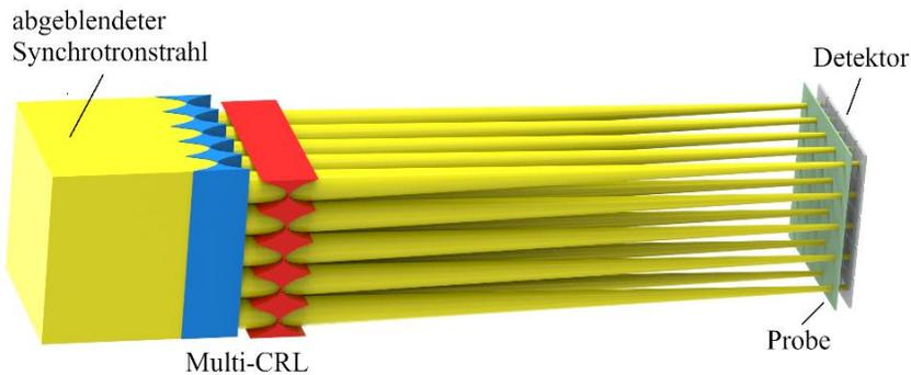
**Abb. 2.15:** Prinzip der rasternden Röntgenmikroskopie mit einem Feld von Foki. Ein Röntgenstrahl wird durch eine Multi-CRL in ein Feld von Foki gebündelt. Die Probe wird in der Fokusebene platziert, direkt dahinter der Detektor. Der Abstand der Detektorpixel entspricht dem Abstand der Foki, so dass die Foki ohne Probe vor den Pixelmitten des Detektors liegen.
