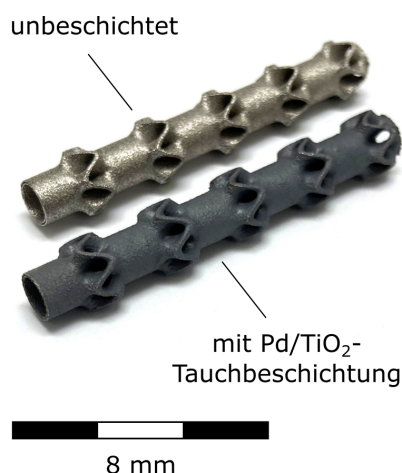
Abb. 4.20.: Bild eines SLE: vor und nach der Aufbringung des 1 wt.-% Pd/TiO 2 -Katalysators über das Tauchbeschichtungsverfahren, angepasst aus [196]. Die aufgebrauchte Beschichtung ist deutlich an ihrer schwarzen Färbung zu erkennen.
