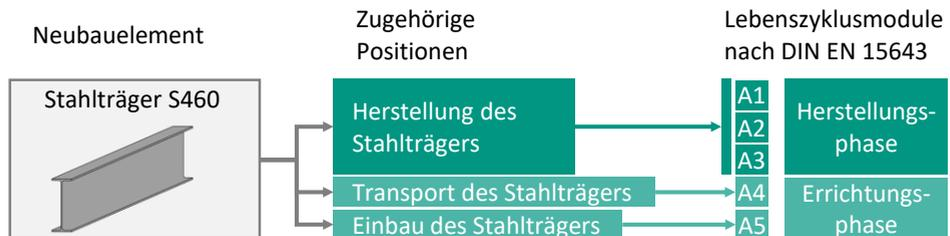
**Abbildung 5.1: Zuordnung der Positionen eines Elements zu verschiedenen Lebenszyklusmodulen**
