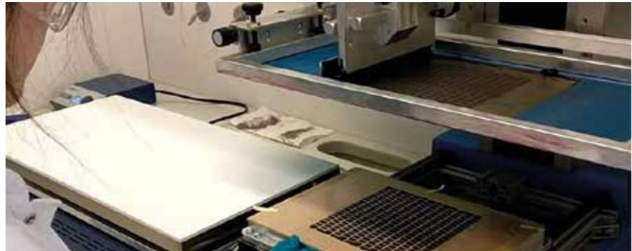
**DAS PROJEKT ORTHOGONAL BEFASST SICH MIT DER HERSTELLUNG VON TEGS DURCH 2D-DRUCKEN MIT ANSCHLIESSENDEM 3D-FALTEN. DEN DRUCKPROZESS HABEN DIE FORSCHENDEN IN DEN LETZTEN JAHREN INTENSIV ANALYSIERT UND WEITERENTWICKELT.**
