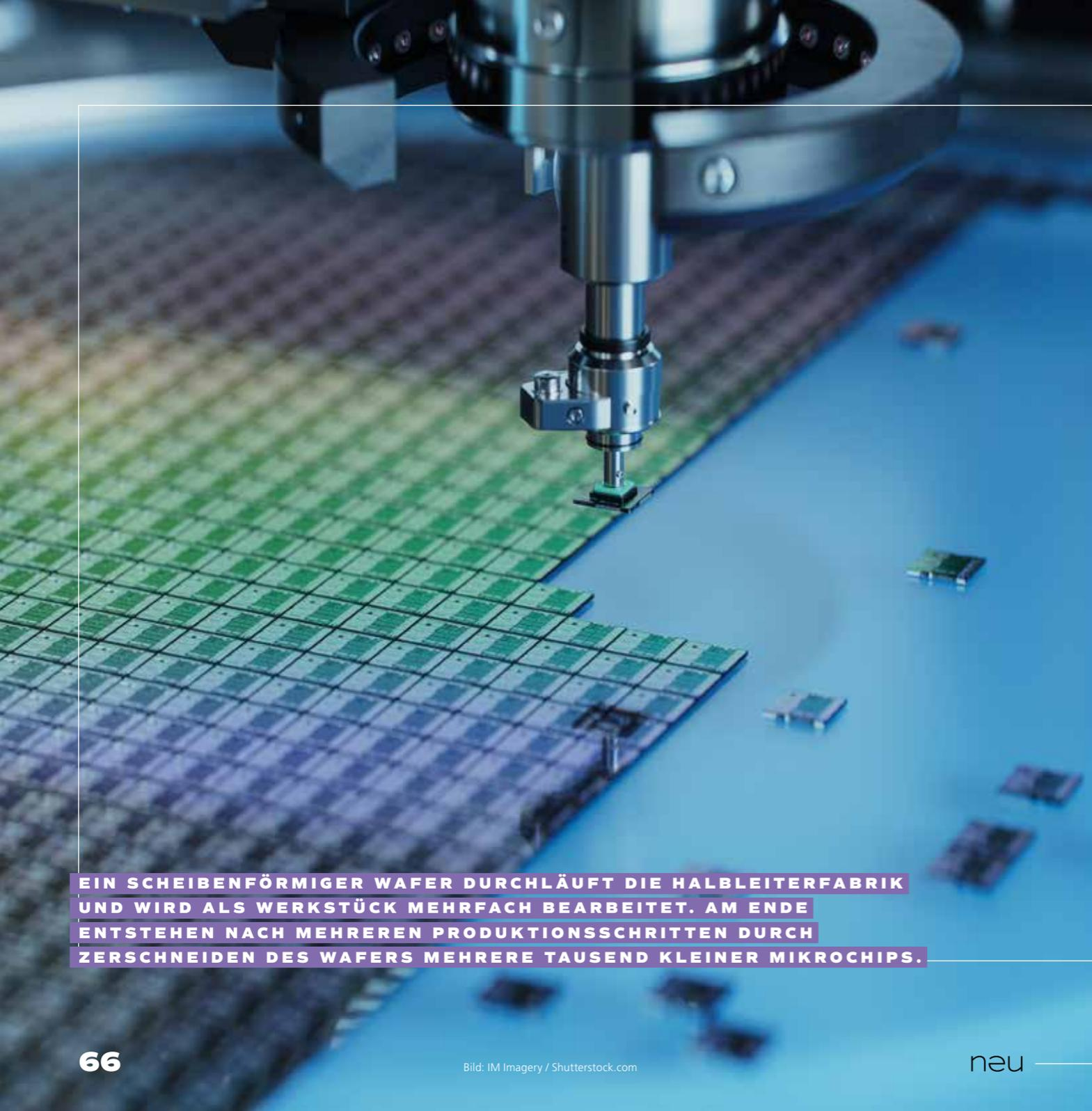
**EIN SCHEIBENFÖRMIGER WAFER DURCHLÄUFT DIE HALBLEITERFABRIK UND WIRD ALS WERKSTÜCK MEHRFACH BEARBEITET. AM ENDE ENTSTEHEN NACH MEHREREN PRODUKTIONSSCHRITTEN DURCH ZERSCHNEIDEN DES WAFERS MEHRERE TAUSEND KLEINER MIKROCHIPS.**
