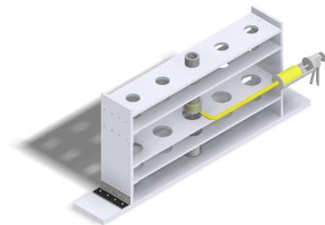
5. Klebstoffapplikation durch Injektion an der Unterseite des zylindrischen Fügspalts
