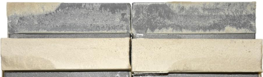
Abbildung A.5: Zugversuche an geklebten Überlappverbindungen: Exemplarische Bruchbilder für die Konfigurationen A (oben) und C (unten) mit einer Überlapplänge von 20 mm; Klebstoff PUR
