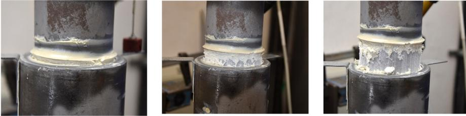
Abbildung 6.10: Zugversuche an geklebten KHP-Steckverbindungen: Exemplarische Dokumentation des fortschreitenden Versagens der Klebschicht im Versuchsverlauf für die Konfiguration A mit einer Überlapplänge von 60 mm; Klebstoff PUR
