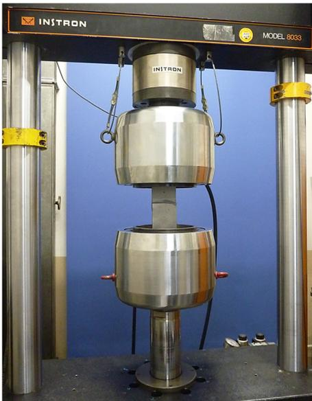
Abbildung 7.1: Versuchsaufbau der dynamischen Versuche an geklebten Überlappverbindungen
