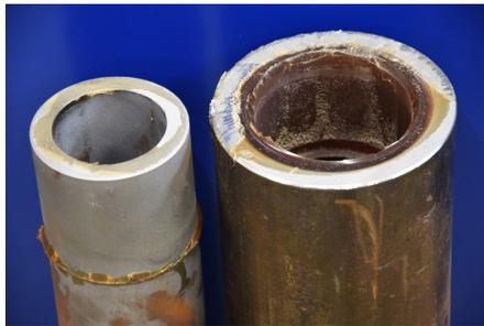
Abbildung A.6: Zugversuche an geklebten KHP-Steckverbindungen: Exemplarische Versagens- und Bruchbilder für die Konfiguration A (oben) und C (unten) mit einer Überlappungslänge von 60 mm; Klebstoff EPH
