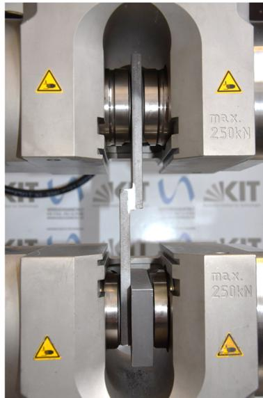
Abbildung 6.1: Versuchsaufbau der statischen Zugversuche an Überlappverbindungen
