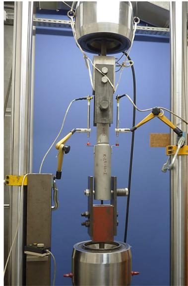
Abbildung 6.2: Versuchsaufbau der statischen Zugversuche an KHP-Steckverbindungen
