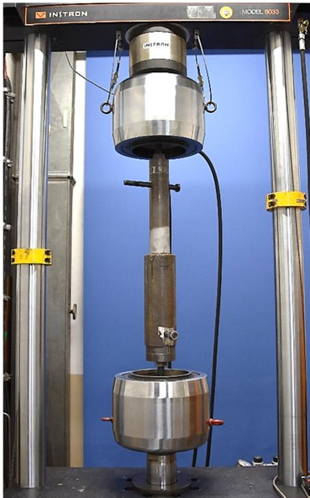
Abbildung 7.3: Versuchsaufbau der dynamischen Versuche an KHP-Steckverbindungen (Damm et al. 2021b)
