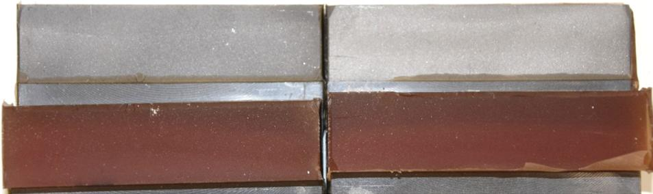
Abbildung A.4: Zugversuche an geklebten Überlappverbindungen: Exemplarische Bruchbilder für die Konfigurationen A (oben) und C (unten) mit einer Überlapplänge von 20 mm; Klebstoff EPH
