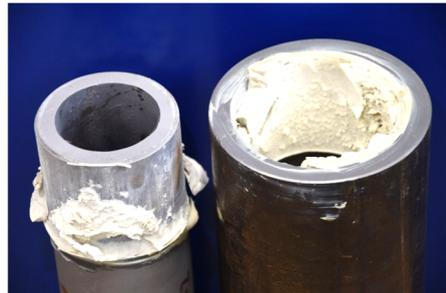
Abbildung A.7: Zugversuche an geklebten KHP-Steckverbindungen: Exemplarische Versagens- und Bruchbilder für die Konfiguration A (oben) und C (unten) mit einer Überlapp-länge von 60 mm; Klebstoff PUR
