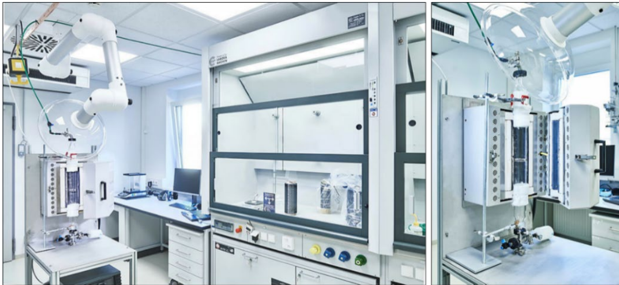
Abbildung 5: Für das Projekt eingerichtetes CF-Labor zur thermischen Beanspruchung von Carbonfasern mit speziellen HEPA-Abzügen (links), sowie Detailaufnahme des vertikal durchströmten Rohrreaktors (rechts).
