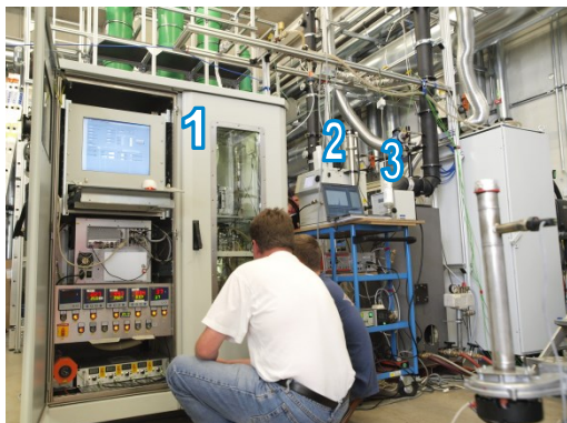
Abbildung 5.6: 2 Verschiedene Perspektiven des Versuchsaufbaus am Technikum des IFK während der Messkampagne mit dem Kaminofen (Nummerierungen: 1. Expositionseinheit; 2. SMPS; 3. CPC)
